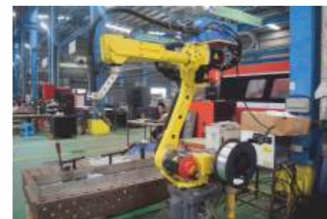
全自动机械手 Robot Welding
